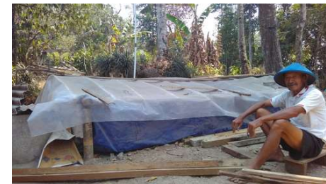
Biofertilizer mempercepat produksi gas metan pada reaktor Biogas (Sleman 2014)
