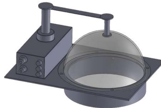
Desain alat Closed Chamber untuk metode Soil Flux yang digunakan dalam deteksi dini Ganoderma pada perkebunan kelapa sawit. Alat ini berfungsi untuk mengukur perubahan emisi gas karbon dari tanah, yang menjadi indikator keberadaan penyakit Ganoderma, sehingga memungkinkan tindakan preventif yang lebih cepat dan efektif.
