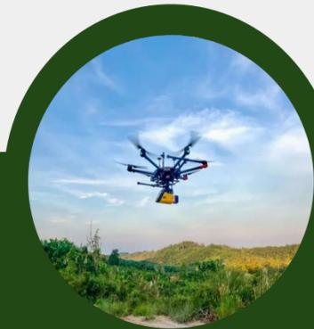
**Pemantauan lahan kelapa sawit dapat dilakukan dengan menggunakan UAV dan mengambil gambar orthophoto area perkebunan kelapa sawit sehingga dapat dilakukan evaluasi terhadap lahan produksi untuk mengurangi hal - hal yang tidak diinginkan terjadi (Deni, 2018).**
